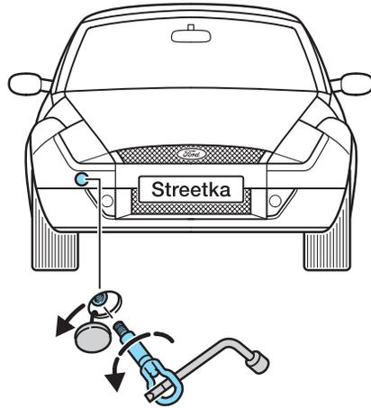
⚠ Im abgeschleppten Fahrzeug muss die Zündung (Stellung II) eingeschaltet sein, damit Lenkung, Blinker und Bremsleuchten funktionieren. Weil bei stehendem Motor die Brems- und Lenkhilfe ausfallen, muss mehr Kraft zum Bremsen und Lenken aufgebracht und mit längeren Bremswegen gerechnet werden.
