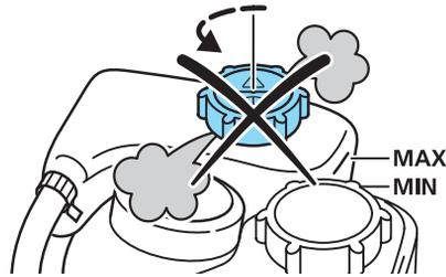
Die Füllhöhe ist von außen im durchsichtigen Ausgleichsbehälter erkennbar. Der Flüssigkeitsspiegel soll bei abgekühltem Motor zwischen **MIN**- und **MAX**-Markierung liegen. Warmes Kühlmittel dehnt sich aus und kann deshalb über die **MAX**-Markierung ansteigen.
