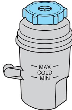
Der Ölspiegel soll bei abgekühltem Motor bis zur **MAX**-Markierung des durchsichtigen Vorratsbehälters reichen.
