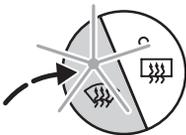
Das System arbeitet nur bei laufendem Motor und beheizt auch die Waschdüsen auf der Motorhaube. Zum Ein-/Ausschalten Taste drücken.
